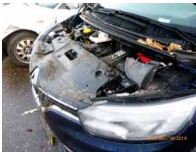
FIGUUR 3 TOTAAL VERLIES RENAULT. WATERDUIKER MET MOTOR- SCHADE TEN GEVOLGE VAN WATERSLAG.
