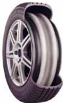
De BSR van Bridgestone is een kunststofring op de velg. Bij het lekrijden gaat de band op de ring lopen, waardoor ze hoogte en stabiliteit behoudt.
