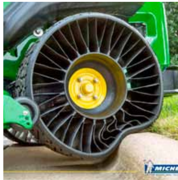
Michelin ontwikkelde de Tweel, een airless tire voor landbouwvoertuigen.
