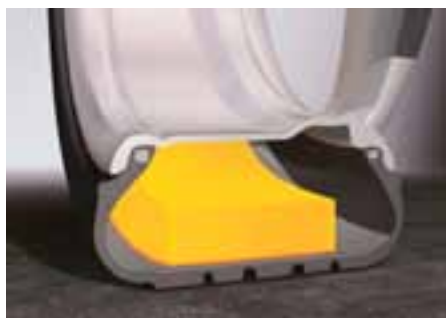
Een laag schuimrubber aan de binnenkant van het loopvlak zorgt voor minder bandengeluid.
