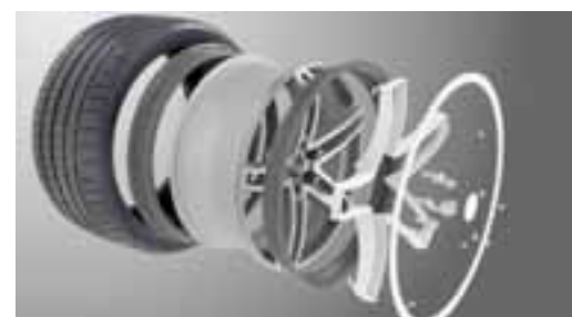
Bij de Flexible Wheel van Michelin wordt de band op flexibele tussenringen geplaatst. Dat voorkomt schade en zorgt voor meer comfort.
