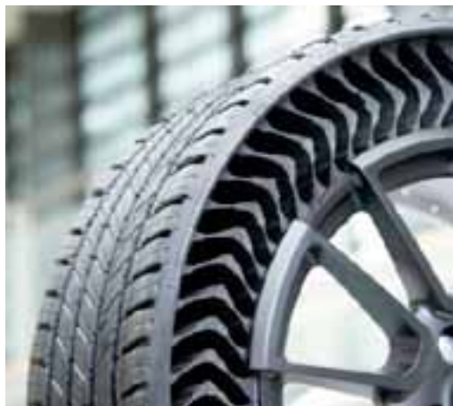
De Uptis is een airless band voor personenauto's, die samen met GM doorontwikkeld wordt.
