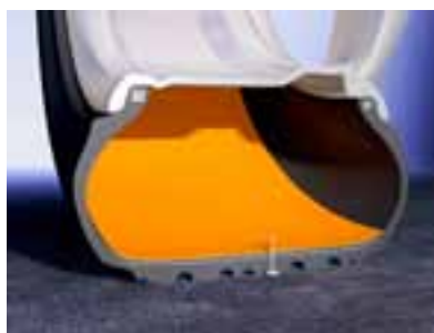
Bij de Flexible Wheel van Michelin wordt de band op flexibele tussenringen geplaatst. Dat voorkomt schade en zorgt voor meer comfort.
